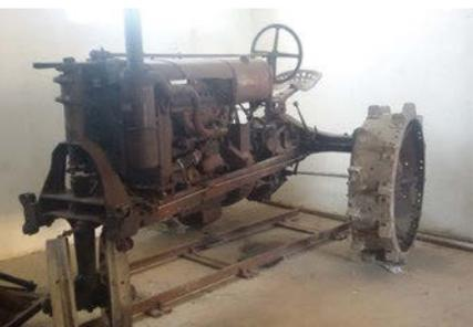
■ Farmall Regular F10, produttore International Harvester, ruote in ferro, motore 4 cilindri benzina, sterzo manuale con inserimento automatico di freni di svolta, conservato, perfettamente funzionante.
