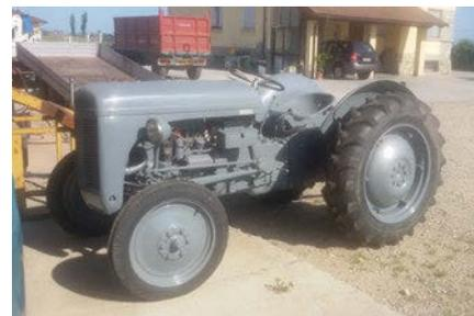
■ Ferguson TH 20, "il piccolo trattore grigio", con il suo innovativo sollevatore idraulico a tre punti con sforzo controllato ancora oggi utilizzato sui moderni trattori per l'attacco e il controllo degli attrezzi.
