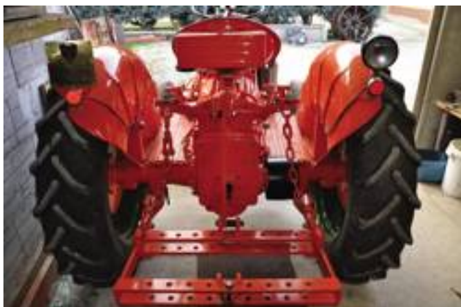
■ Il DA 30 visto da dietro. Si notino la pdp e la puleggia.
